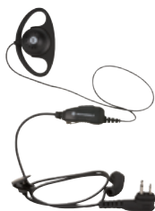
Наушник-ракушка со встроенным микрофоном и связью в режиме Push-To-Talk
