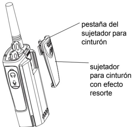
1. Deslice los rieles del sujetador para cinturón con efecto resorte en las ranuras del sujetador que se encuentran en la parte posterior de la batería y deslice el sujetador hacia abajo hasta que la pestaña del sujetador quede en su lugar.
