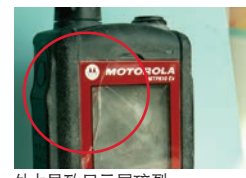
外力导致显示屏碎裂
