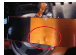
外力导致外壳排线损坏
