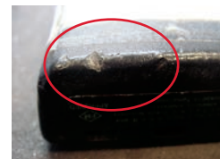
外力损坏导致外壳出现深坑
