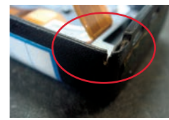
外壳外力损坏导致外壳开裂
