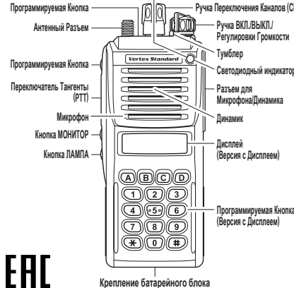
Крепление батарейного блока
