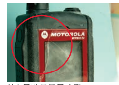
外力导致显示屏碎裂
