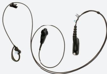
此款双线监听耳机的一条线设计为耳机，另一条线是麦克风和PTT通话按钮。用户可以方便的把耳机固定在制服上，是一款理想的公务用耳机。通话时，把麦克风拉到嘴边以压低声音通话。摩托罗拉最先进的IMPRES智能技术可以提供自适应的音频传输，不论在嘈杂还是安静的环境中都能进行清晰的对讲通话。
