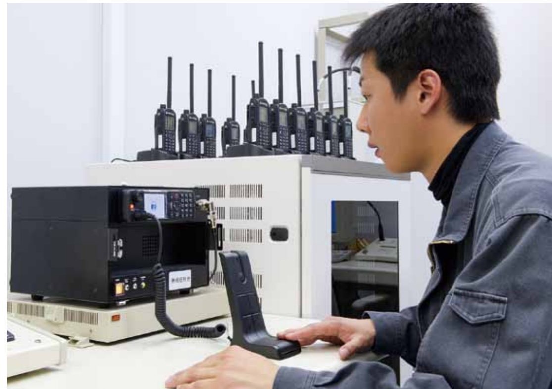
総務課に設置された統制機能付きの半固定型・移動局と持ち出し対応の携帯型・無線装置
