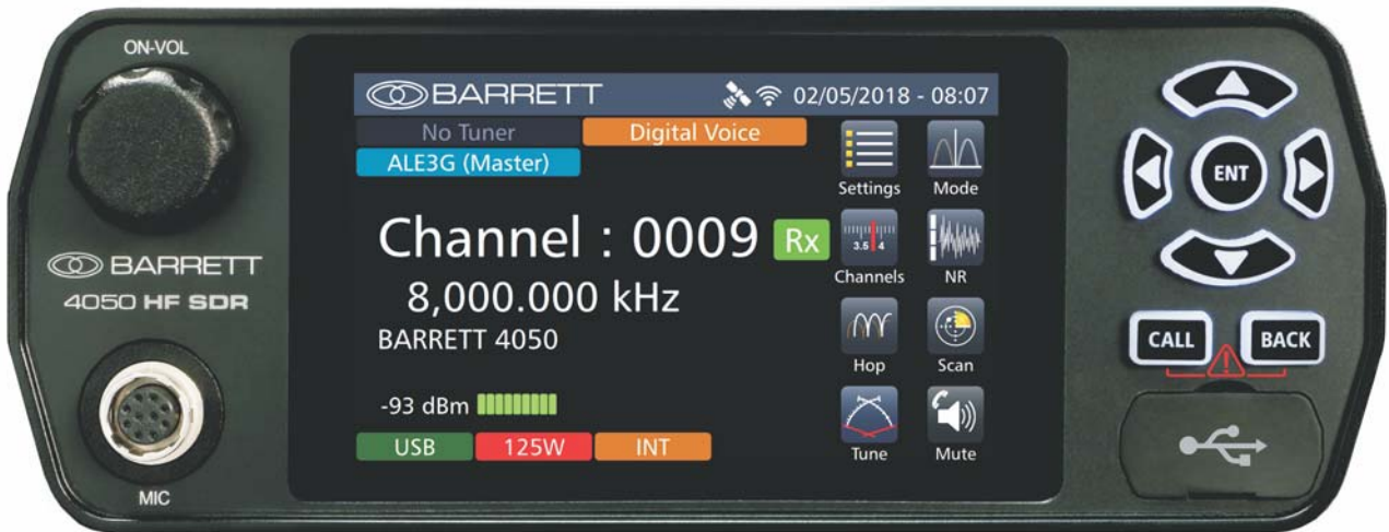
Передняя панель КВ-трансивера Barrett 4050 SDR
