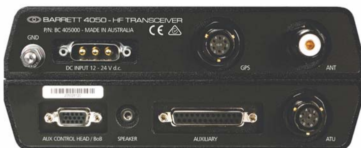
Задняя панель КВ-трансивера Barrett 4050 SDR
