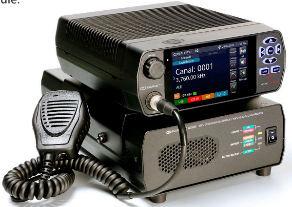
Barrett 4050 HF SDR avec alimentation 4022 en configuration de station de base.
