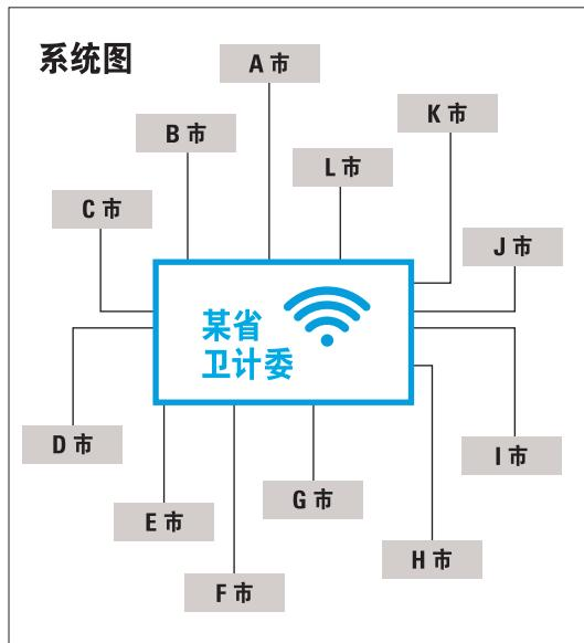
本次全省卫生应急通讯系统建设规划以省卫计委、各地市为单位，每个单位各配一台背负式基站、车载电台和数字对讲机若干。数字背负式基站共 13 台，数字车载台 13 台、数字手持对讲机 1200 多台。
