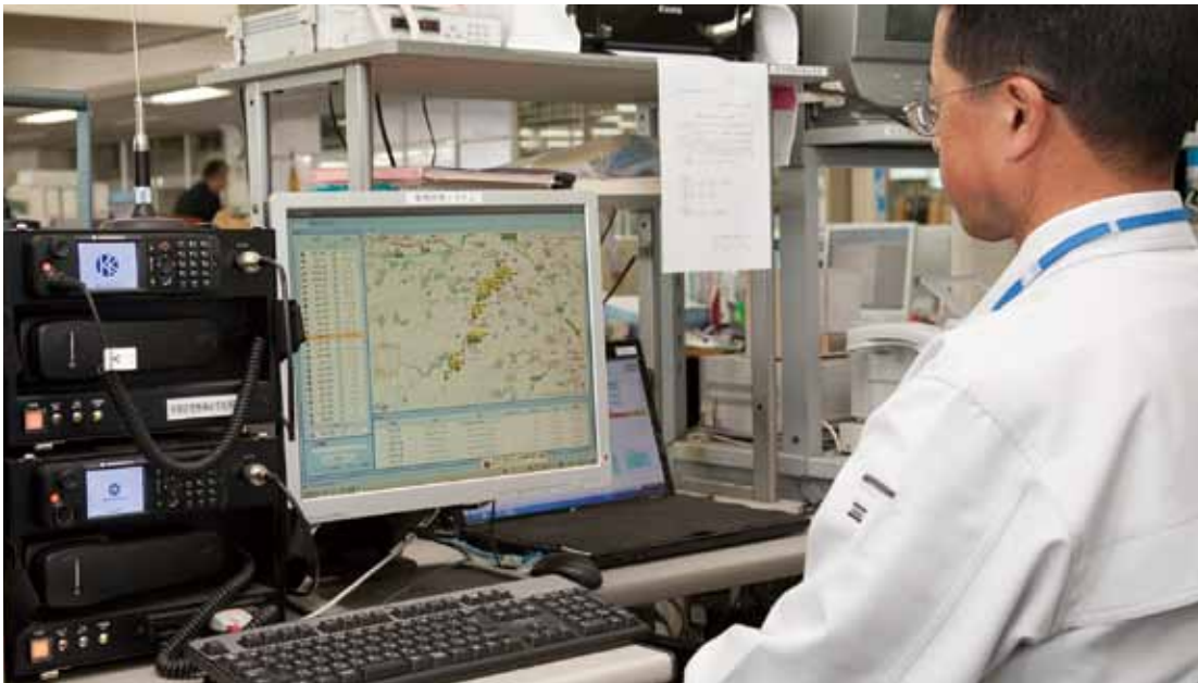
防災環境課に設置された半固定型・無線装置とGPS 動態管理装置
